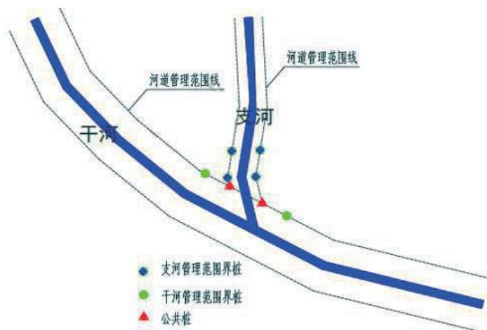
图 4.4.3-1 干支流交汇处无控制性建筑
