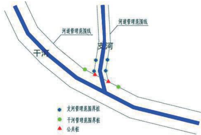
图4.4.3-1 干支流交汇处无控制性建筑
