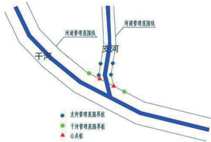
图4.4.3-1 干支流交汇处无控制性建筑
