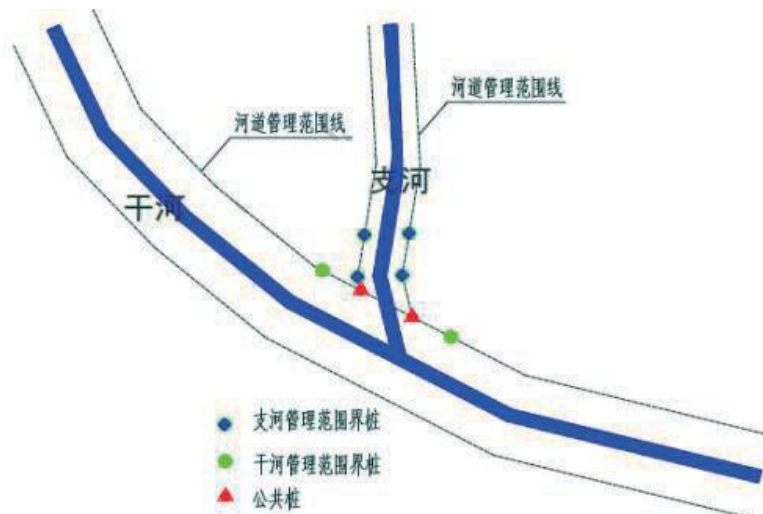
图 4.4.3-1 干支流交汇处无控制性建筑
