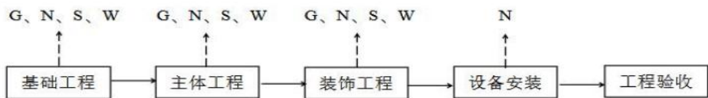
图 2.8-1 施工期工艺流程及产污环节
