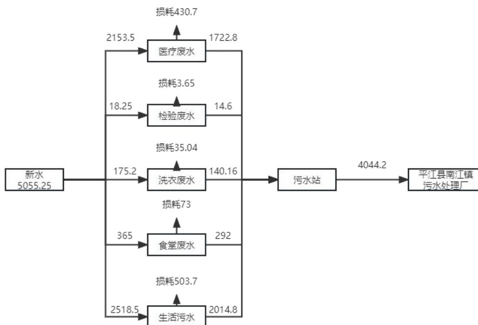
图 2-1 水平衡图 单位 m³/a
